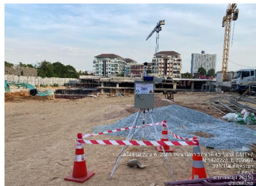
รูปที่ 21 ตั้งเครื่องตรวจวัดคุณภาพสิ่งแวดล้อม คุณภาพอากาศ ระดับเสียง เสียงรบกวน ความสั่นสะเทือน
