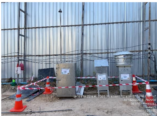
รูปที่ 21 ตั้งเครื่องตรวจวัดคุณภาพสิ่งแวดล้อม คุณภาพอากาศ ระดับเสียง เสียงรบกวน ความสั่นสะเทือน
